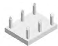
Losa de cimentación
